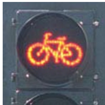
Figura 17 - Grupo focal para ciclistas - NACTO Urban Bikeway Design Guide - April 2011 Edition [13] - Foco amarelo com pictograma
