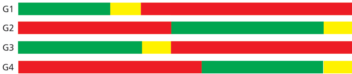
Figura 8 - Caso em que há dois grupos semafóricos com direito de passagem no Estágio 1 e dois grupos semafóricos com direito de passagem no Estágio 2
