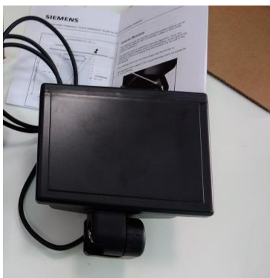
Figura 5: Sensor Heimdall on Crossing direcional para área de travessia
