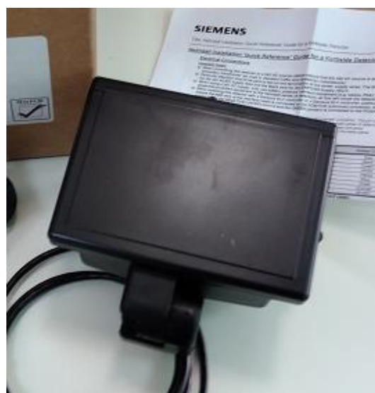
Figura 6: Sensor Heimdall Kerbside simples para área de espera
