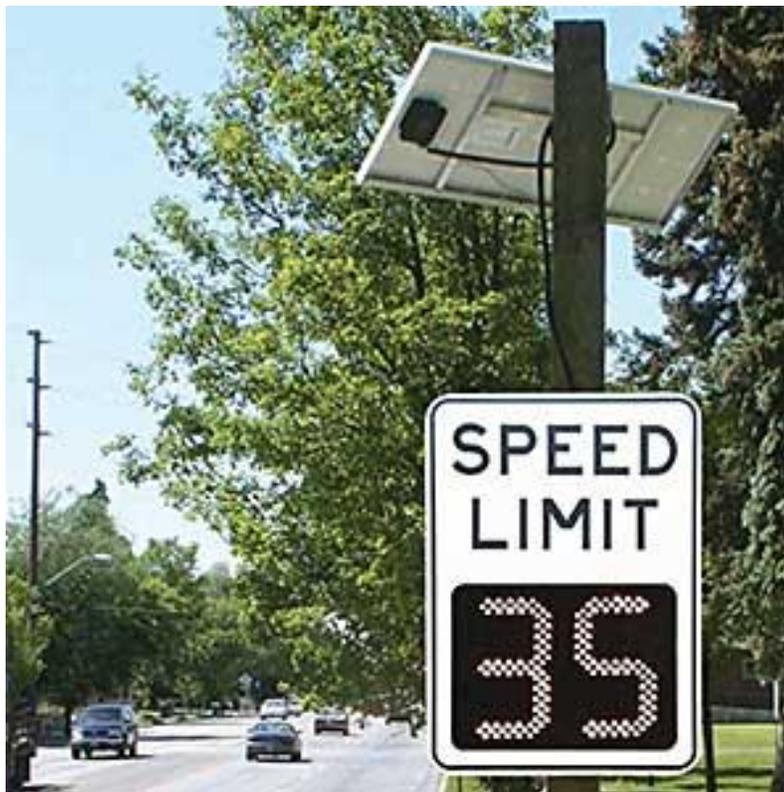
Figura 2: Exemplo de dispositivo para exibição de limite variável de velocidade constituído de pequeno PMV de LEDs, emoldurado pela placa de velocidade.
