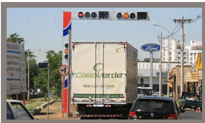
Figura A-9 – Grupos focais instalados em semi-pórtico, com contagem regressiva para a conversão à esquerda e em frente, em São José do Rio Preto – SP
