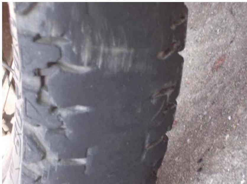
**Fotografia nº 8:** Vestígio da frenagem do veículo, após a colisão.
