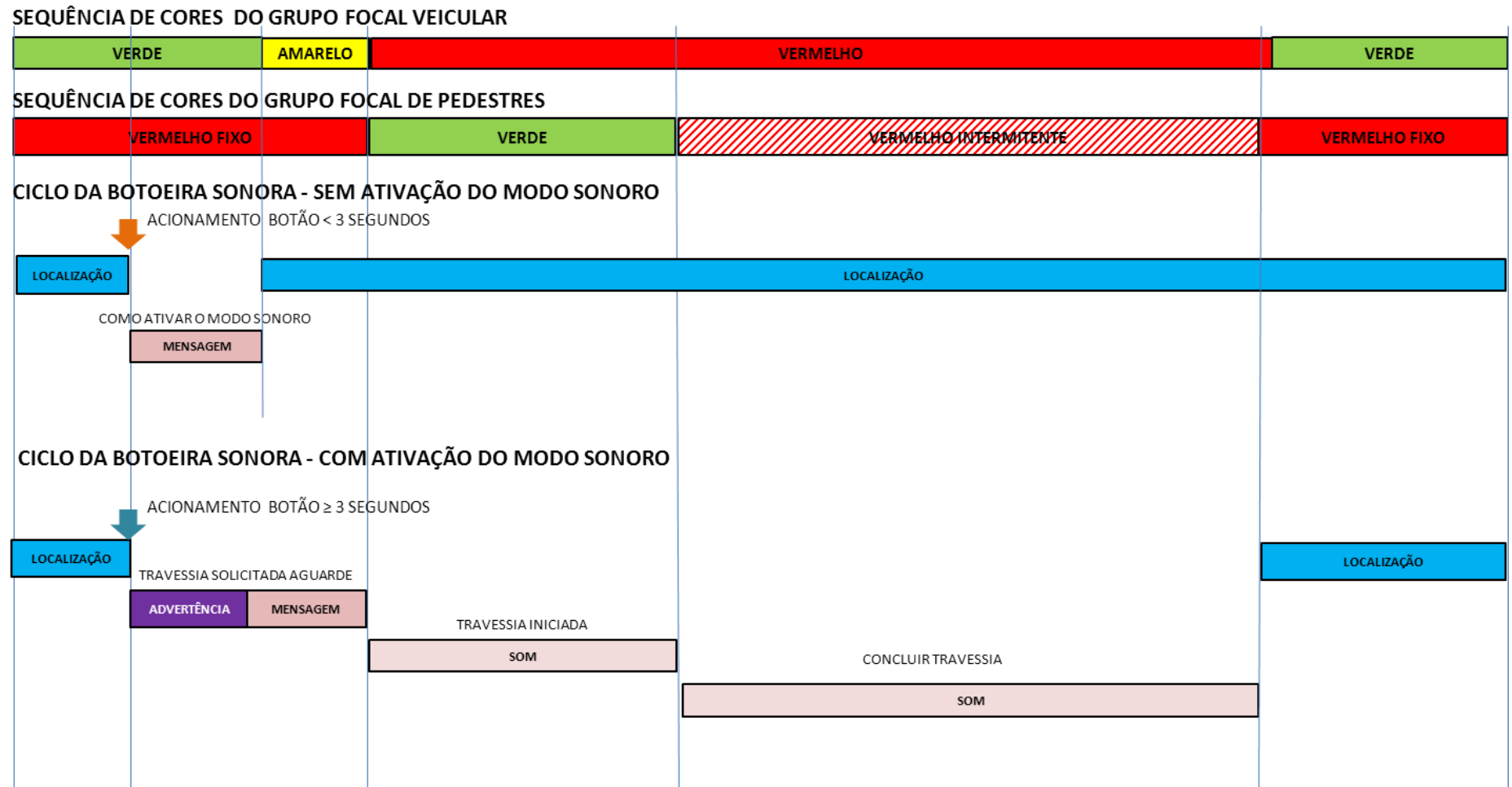
Figura 2 – Ciclo de funcionamento da Botoeira Sonora
